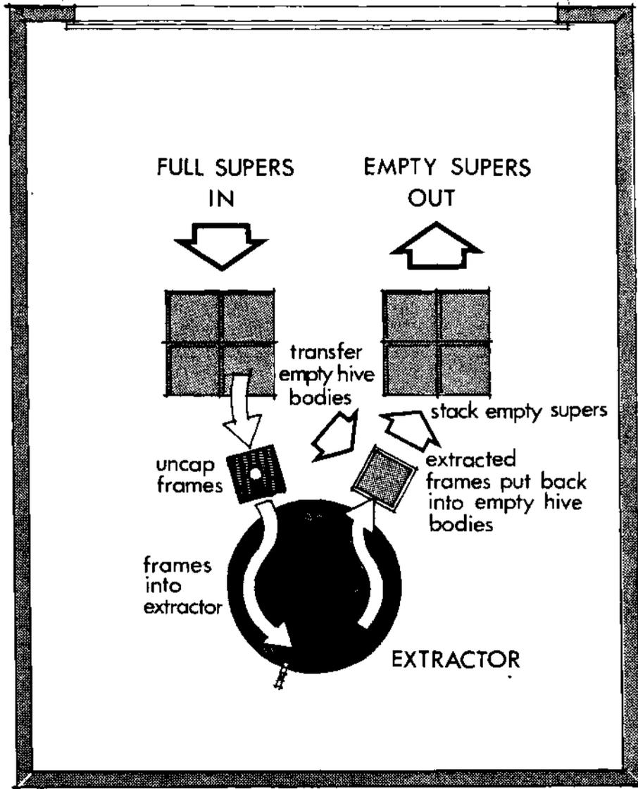
FIGURE 1: U-FLOW FOR HIVE PARTS IN A GARAGE TYPE OPERATION
