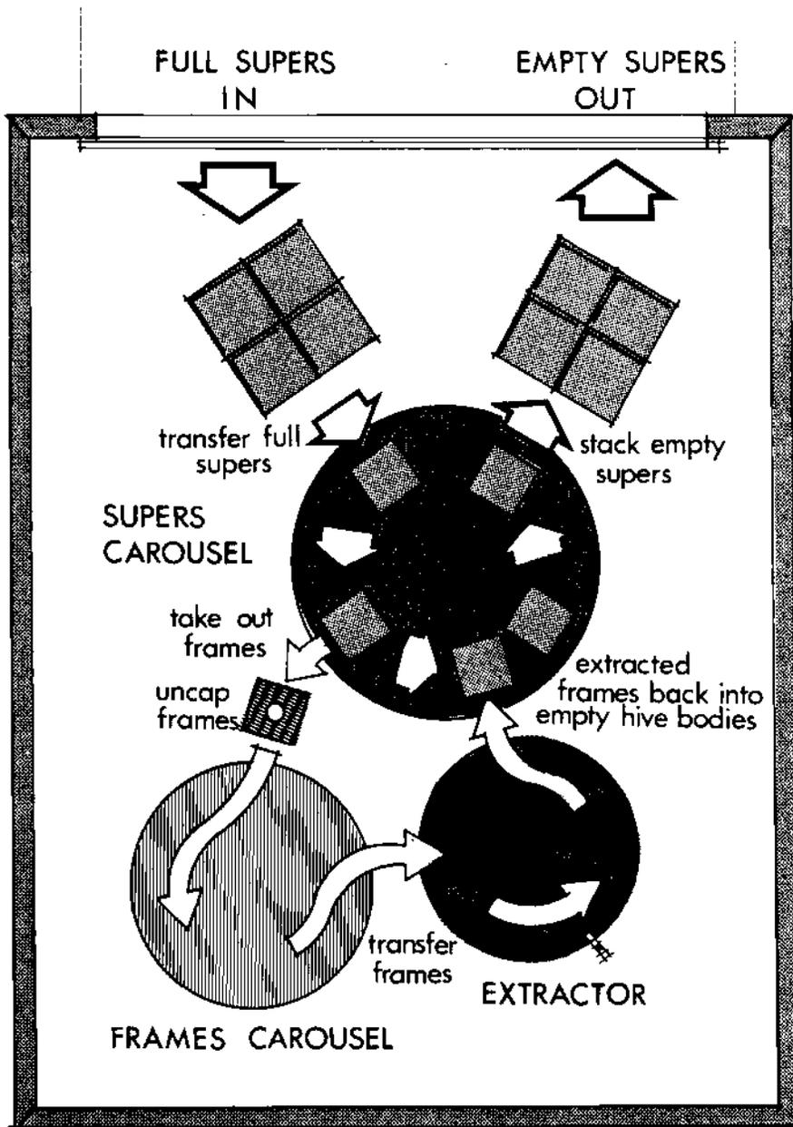
FIGURE 2: U-FLOW USING CAROUSELS IN A GARAGE TYPE OPERATION
