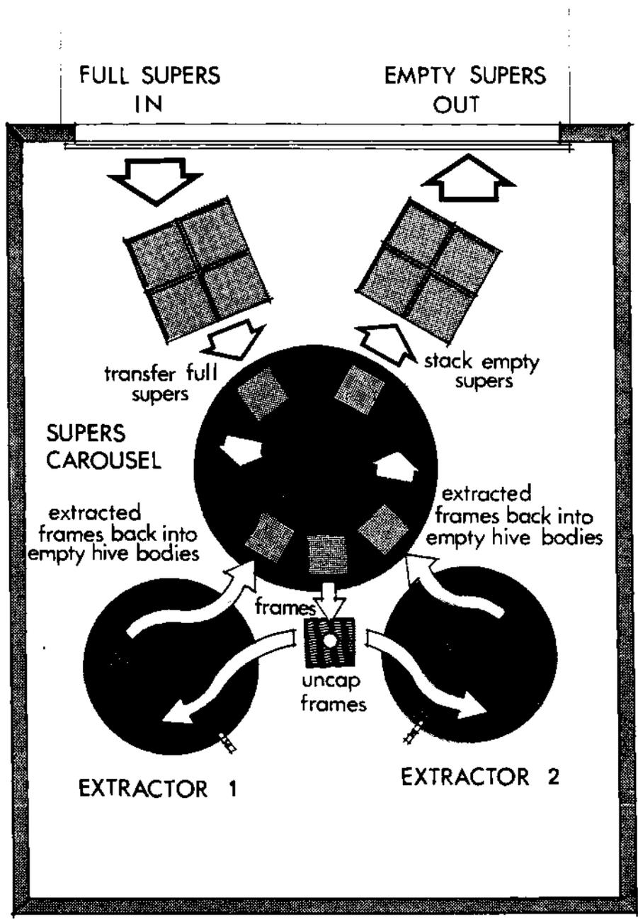
FIGURE 3: U-FLOW USING TWO EXTRACTORS IN A GARAGE TYPE OPERATION
